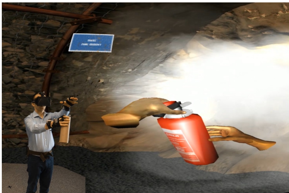
Rys. 1. Stanowisko szkoleniowe o wysokim poziomie immersyjności. Na obraz obserwowany przez osobę szkoloną w okularach rzeczywistości wirtualnej nałożony został obraz z sali szkoleniowej. Osoba szkolona ma na sobie okulary rzeczywistości wirtualnej, rękawice oraz zamocowaną na pasie antenę umożliwiającą bezprzewodową transmisję obrazu (co pozwala na swobodne przemieszczanie się po sali szkoleniowej). Ilustracja przedstawia fragment szkolenia związany z gaszeniem płonącej ściany przodka. Gaszenie odbywa się z wykorzystaniem atrapy gaśnicy
