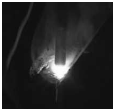
Obr. 3. Pohľad cez kuklu zvárača do miesta zvaru [zdroj: autor]
