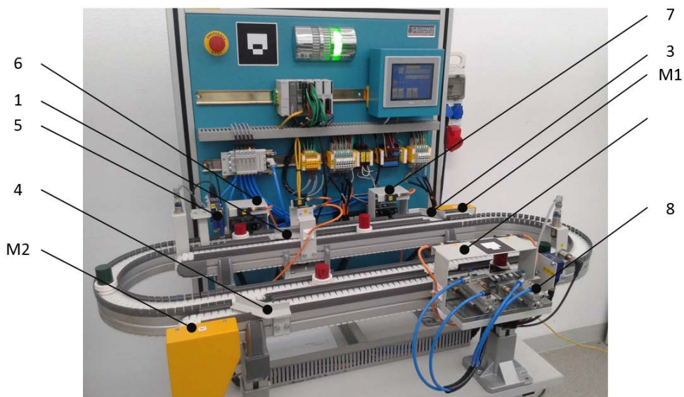
Rys. 5. Stanowisko dydaktyczne do e-learningu programowania sterowników PLC w zakresie transportu technologicznego
